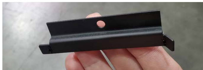
Figure 20.b Pliez la languette latérale de droite
