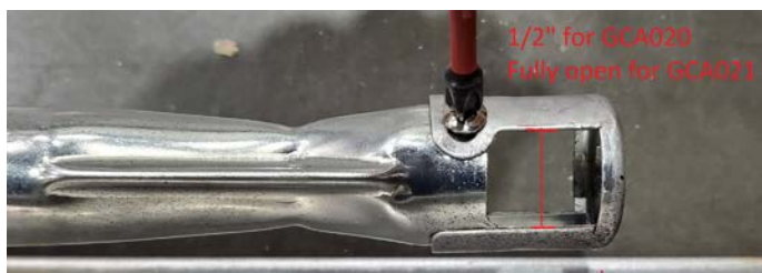
Figure 13.c Organe de réglage de la prise d'air principale
