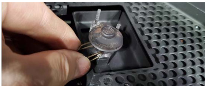
Figure 13.d Retrait de la sauterelle de fixation
