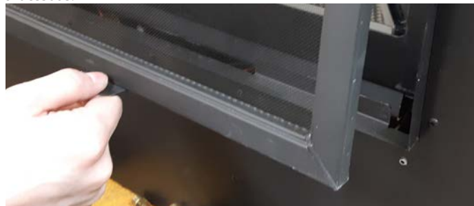
Figure 20.b Soulevez les languettes de retenue et l'écran.
