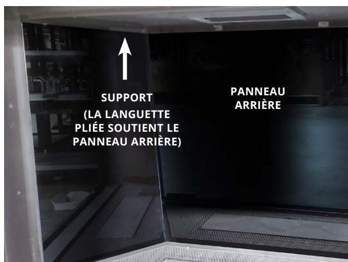
Figure 20.b Fixez-le au support à l'aide de vis
