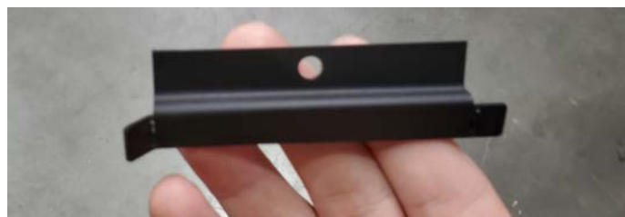
Figure 20.b Pliez la languette latérale de gauche
