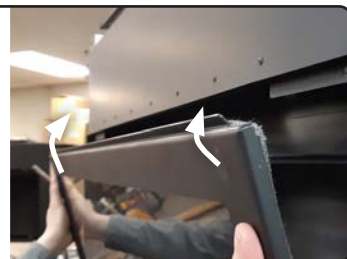
Figure 21.b Installation de la porte
