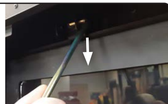
Figure 21.d Tirer sur les verrous de la porte
