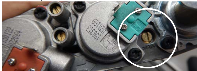
Figure 13.g Réglage de la taille de la veilleuse
