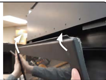
Figure 21.b Installation de la porte
