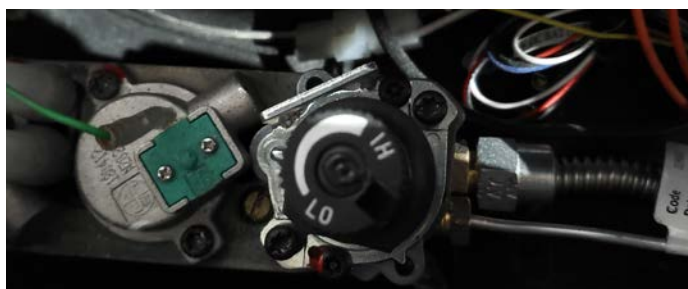
Figure 13.ee Régulateur de pression du pétrole liquéfié sur un modèle de base
